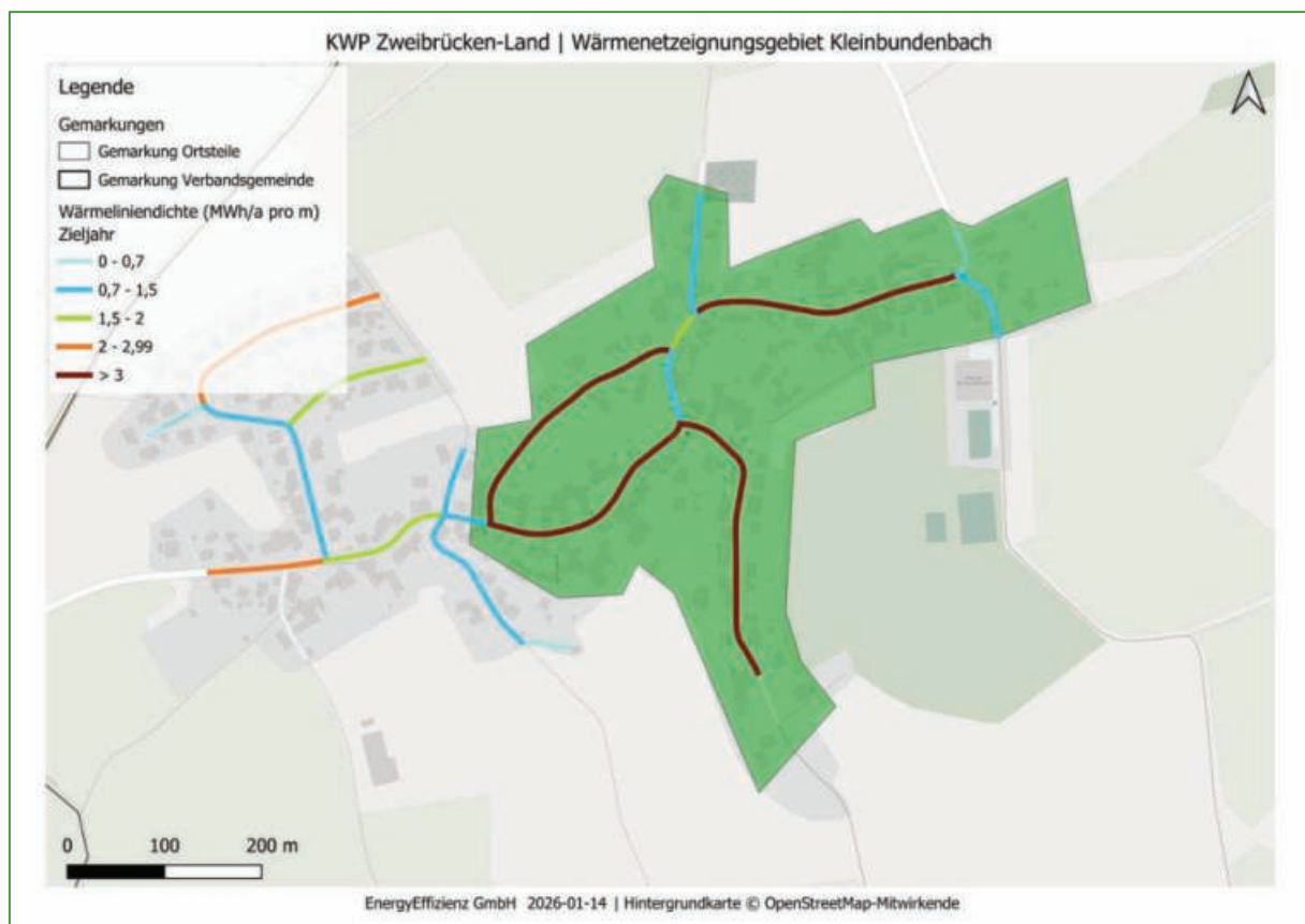
Abbildung 34: Wärmelinienindichte im Wärmenetz Kleinbundenbach, 100 % Anschlussquote
