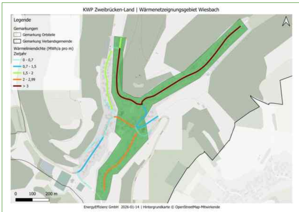
Abbildung 38: Wärmelinienichte im Wärmenetz Wiesbach, 100 % Anschlussquote
