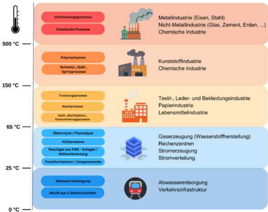
Abbildung 21: Temperaturniveau der Abwärme nach Industriezweigen; Quelle: (Dunkelberg, 2023)
