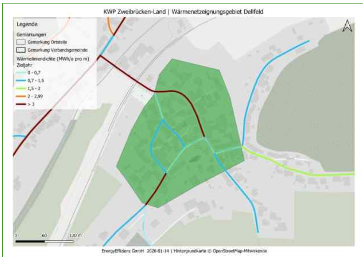
Abbildung 32: Wärmelinienindichte im Wärmenetz Dellfeld, 100 % Anschlussquote
