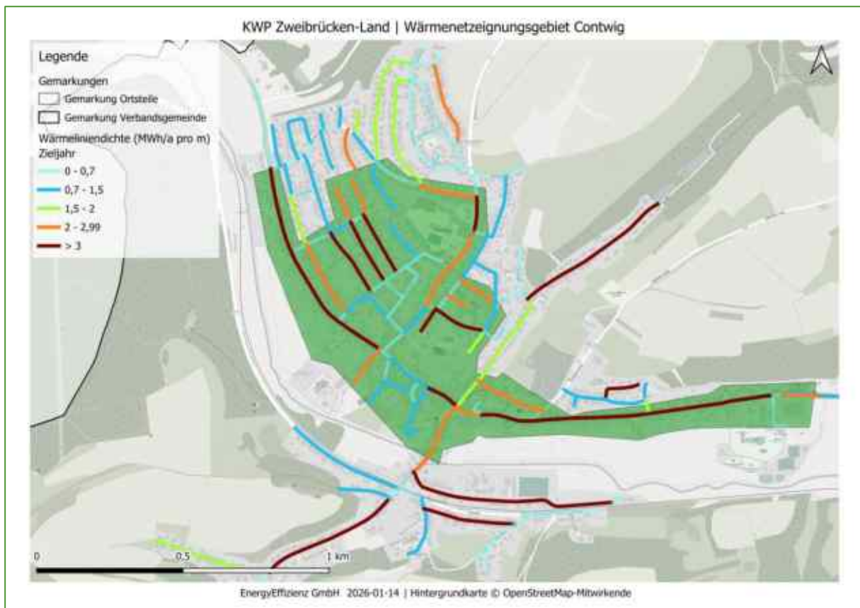
Abbildung 30: Wärmelinienendichte im Wärmenetz Contwig, 100 % Anschlussquote
