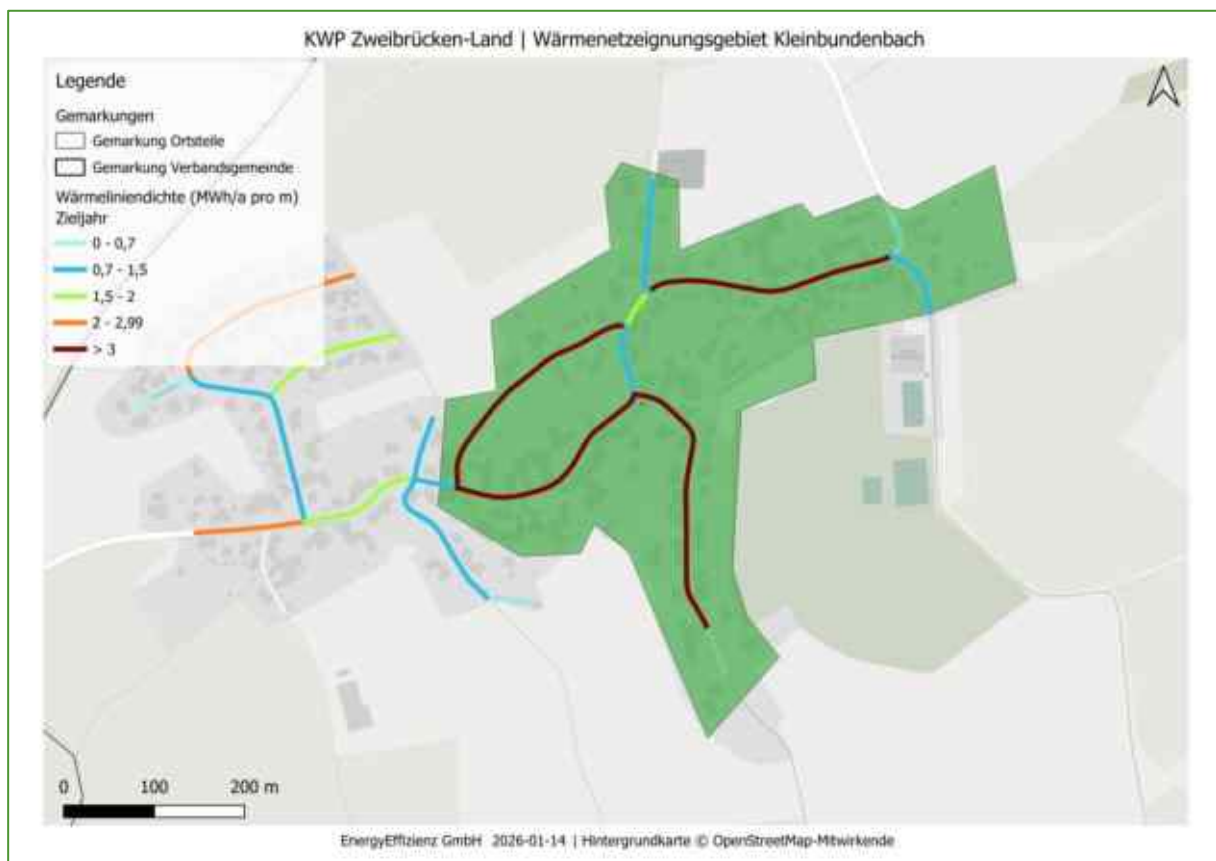
Abbildung 34: Wärmelinienichte im Wärmenetz Kleinbundenbach, 100 % Anschlussquote
