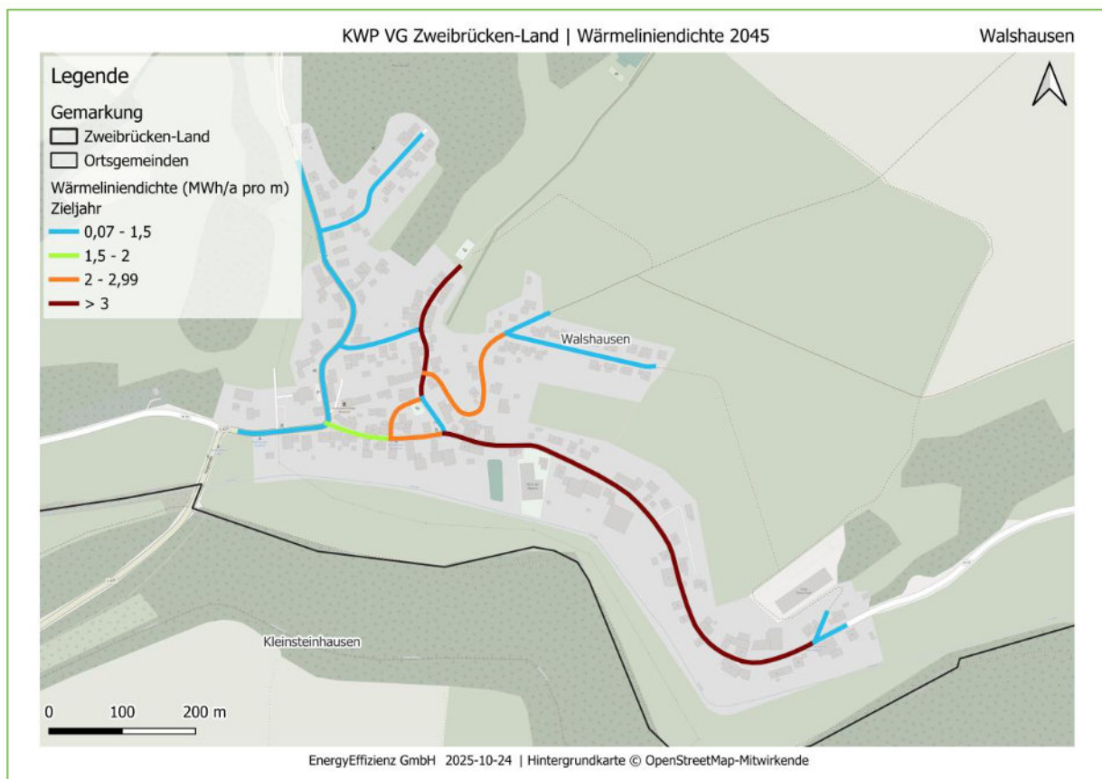
Abbildung 182: Verbandsgemeinde Walshausen: Wärmeliniendichte im Zieljahr 2045
