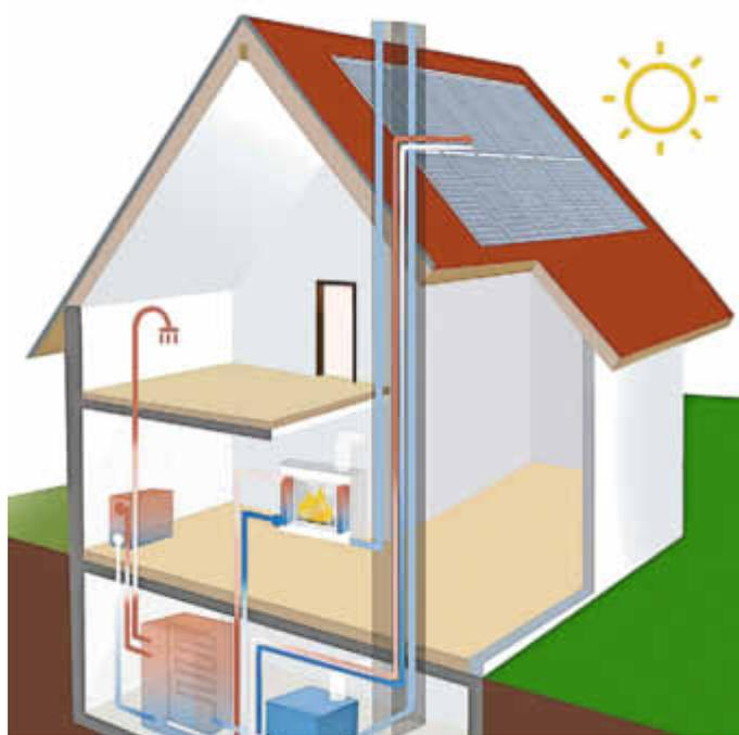
Ein Kamin- oder Kachelofen mit Wassertasche, kombiniert mit einer Solarthermieanlage, kann den niedrigen Heizwärmebedarf moderner Neubauten optimal unterstützen. Grafik: Erlus/interPress
